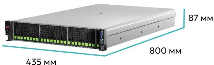
Высокопроизводительный двухсокетный 2U сервер, предназначенный для монтажа в 19" стойку
